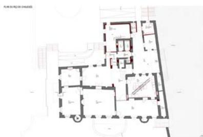
Le plan du Rez-de-chaussée, donc le niveau principal où on voit que l'entrée se fera par la cour. Un dispositif de rampe qui permet d'accéder sans trop de difficulté et l'entrée historique qui va se refaire par cette porte-là alors que l'entrée actuellement se fait par le côté. On arrive sur un grand
