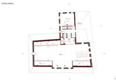
Le plan de tout en haut, sous les toits, dans la charpente. C'est ici qu'il y aura la grande salle polyvalente pour 150 personnes et de 150 m<sup>2</sup>. On a un accès et une sortie de secours. L'accès principal se fait depuis l'ascenseur et la cage d'escalier. Au Nord toujours on a un atelier dédié à la poterie.
